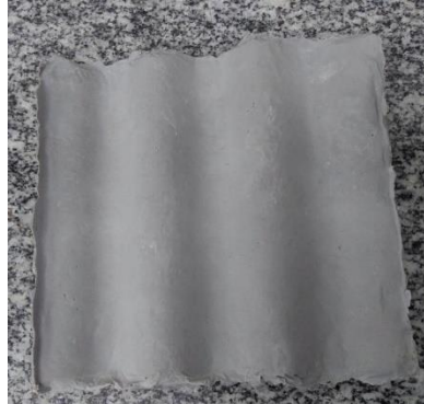
Figura 1: Corpo de Prova produzido em Fibrocimento.
